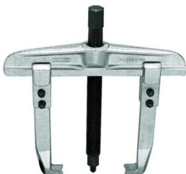
Corpo, garras e suportes forjados em aço especial Gedore e níquelados. Demais componentes fosfatizados. Permite a inversão de suas garras facilitando a extração de polias com apoio externo e interno.
