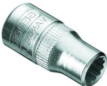
Aço Gedore-Vanadium. Niquelado e Cromado. Para trabalhar com acessórios manuais com encaixe a 6,35 mm (1/4"), conforme DIN 3120-C 6.3, ISO 1174. Facilita trabalhos com pequenos parafusos sextavados. Modelo curto.
