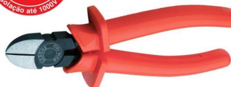
Alicate de corte diagonal, modelo sueco iox isolado NBR9699. Aço Gedore-Vanadium. Fosfatizado e faces lixadas. Tratamento térmico total e indução no corte. Projetado para cortar arame duro de até 1,6 mm.
